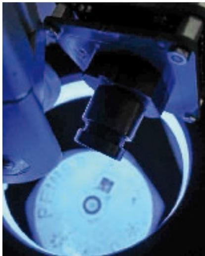
◀ Intelligente Kamera mit M12-Objektiv identifiziert direkt markierten DataMatrix-Code.
