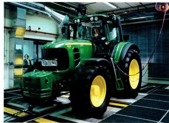
Der Traktor auf dem Prüfstand: Das Punkt-zu-Punkt-Matchen optimiert die Rundlaufeigenschaften des Rades.
