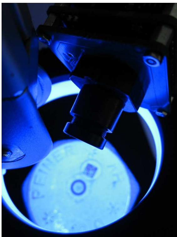
Bild 1: Intelligente Kamera mit M12-Objektiv identifiziert direkt markierten DataMatrix-Codes.
